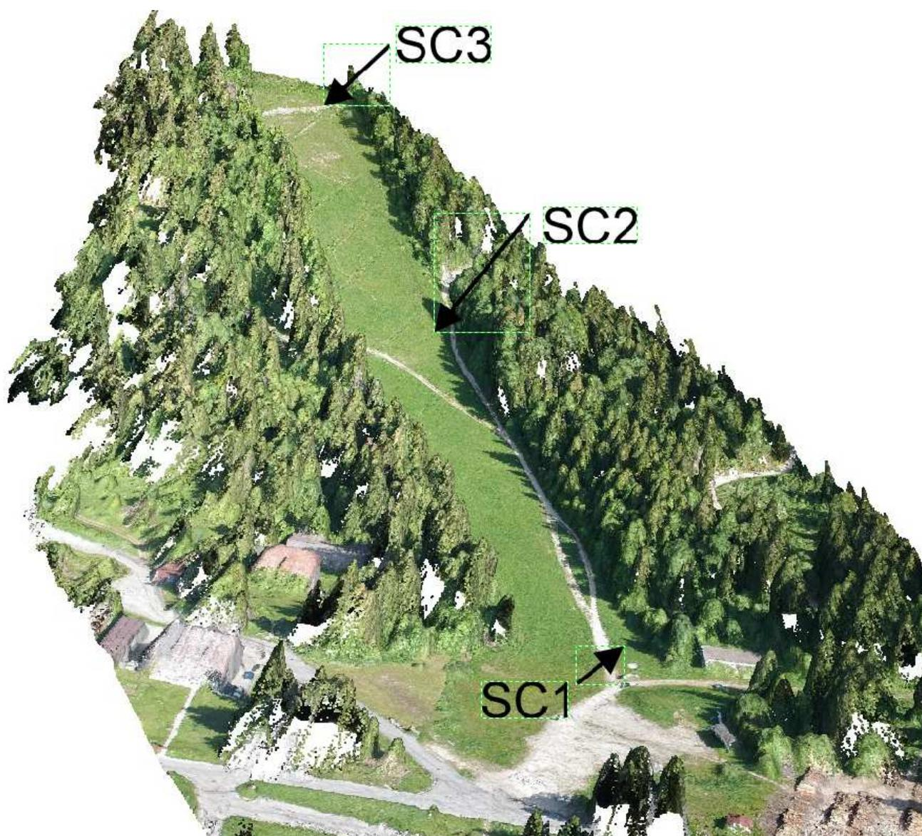
*Ubicazione scavi esplorativi su modello 3D da nuvola punti rilievo drone*
